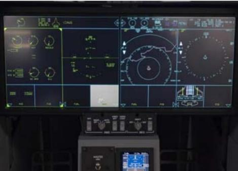
L'F-35 possiede un display di tipo "panoramic cockpit display (PCD)" con dimensioni di 50 x 20 cm. Il display è touchscrteen e multifunzione, che può essere diviso in 3 parti sulle quali vengono visualizzate diverse informazioni intercambiabili
