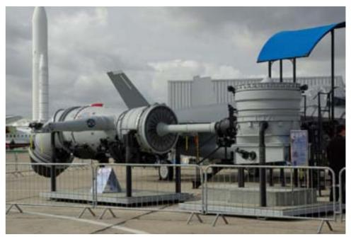
La versione F-35B è dotata di1 turboventola Pratt & Whitney F135-PW-600 che è in larga parte la stessa delle altre versioni ma ha una spinta verticale da 177 kN (39.700 lb) che deriva per il 48% dall'ugello orientabile verso il basso, il 40% dalla ventola dorsale Rolls-Royce/Allison e per il 12% da un sistema di controllo di valvole sulle ali.
